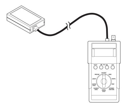
Fig. 4-2. Testing Twisted-Pair Cables.
